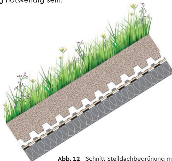
Abb. 12 Schnitt Steildachbegrünung mit Rutschsicherung (BuGG)
